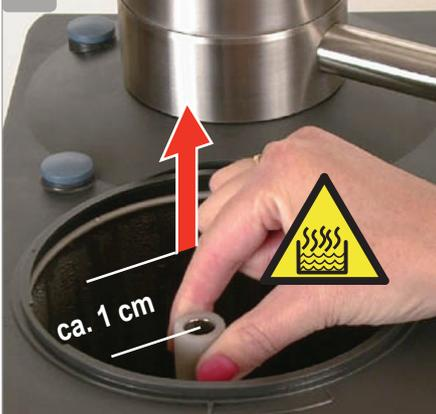
Ziehen Sie die Überlaufleitung am kurzen Schlauch nach oben, um den Heißwassererzeuger vollständig zu entleeren. (Hahn geöffnet!).
