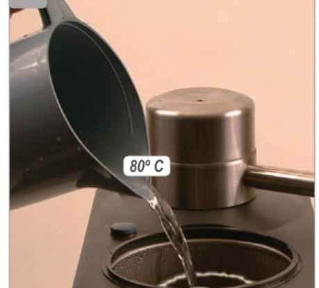
Gießen Sie heißes Wasser in den Heißwassererzeuger bis knapp über die Kalkkante (dies beschleunigt den Entkalkungsprozess).
